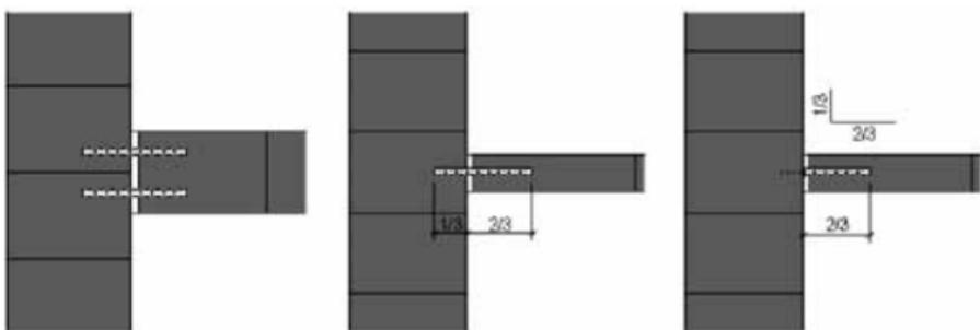
горизонтального шва можно положить два прута ребристой бетонной арматуры диаметром не более 8 мм с нахлестом около 500 мм по обеим сторонам коробки.
