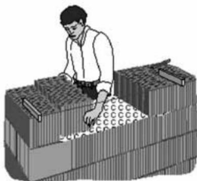
Раствор постельного шва наносится по всей поверхности до наружных граней стены, но не должен выступать наружу, поэтому лишний раствор, вытекающий из постельного шва, убирается с помощью лопатки.
