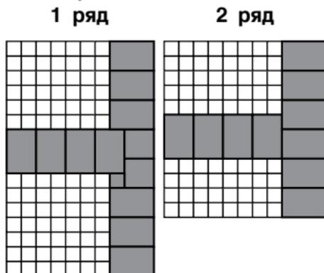
Перевязка с внутренней стеной толщиной 250 мм
