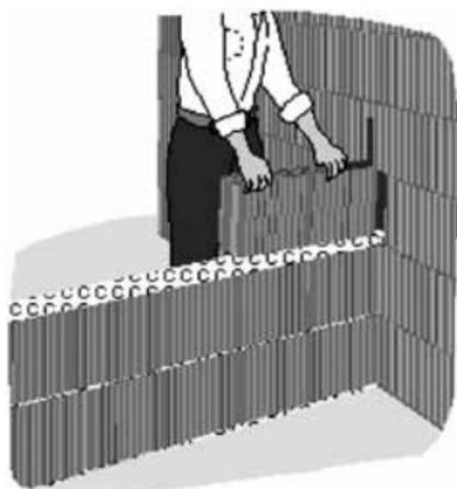
При соединении перегородки с несущей стеной на торцы блоков **POROTHERM 12** нанесите раствор, уложите их и прижмите к несущей стене. При таком типе стыка необходимо укреплять каждый второй постельный шов с помощью плоского анкера из нержавеющей стали (например, с помощью анкера FD KSF компании «Фишер» (FISCHER)). Согнутую под прямым углом горизонтальную часть анкера нужно вдавить в раствор постельного шва, а вертикальную часть – прикрутить с помощью шурупа и дюбеля к несущей стене.
