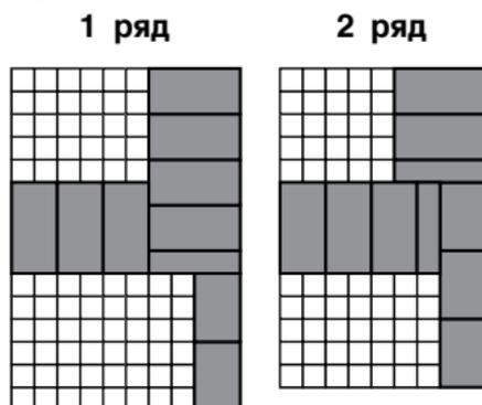
Широкий внешний угол ( $135^\circ$ ) и внутренний угол ( $225^\circ$ ) наружных стен — эркер
