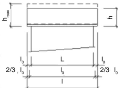
перемычками – зоны распора – можно использовать обожженные, силикатные, бетонные кирпичи и блоки, поперечная прочность которых (т.е. после укладки над перемычками вдоль горизонтальных осей перемычек) составляет в среднем хотя бы 2,5 МПа, а по отдельности – хотя бы 2,0 МПа.
