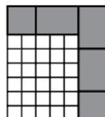
Перевязка с внутренней стеной толщиной 250 мм
