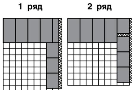
Внутренний угол наружной стены в месте соединения с внутренней стеной толщиной 250 мм
