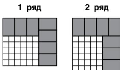
Перевязка с наружной стеной толщиной 380 мм
