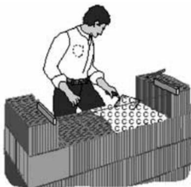
Укладывайте в свежий раствор кирпич за кирпичом вплоты вдоль шнура (перевязка в паз и гребень обеспечивает правильную укладку кирпичей). Положение кирпичей проверяйте по уровню и рейке и поправляйте с помощью резинового молотка. Керамические блоки не должны выступать за фундамент или перекрытие более чем на 25 мм!
